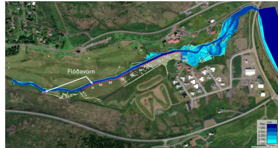
Mynd 2.7 Dýpi vatns við hönnunarflóð, með flóðavörn. Flóðavörnin er sýnd með rauðum lit á mynd. Útbreiðsla flóðs án flóðavarna fyrir sama flóð er sýnd með gráum fláka. Flóðið nær ekki inn á skipulagssvæðið skv. líkaninu. (Verkís 2025)
