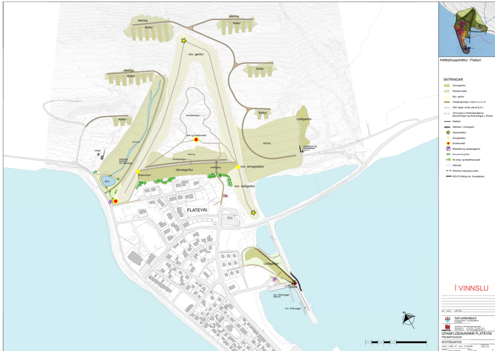
Mynd 1-2 Afstöðumynd sem sýnir vegslóðir og landmótun á fyrirhuguðu framkvæmdasvæði.
